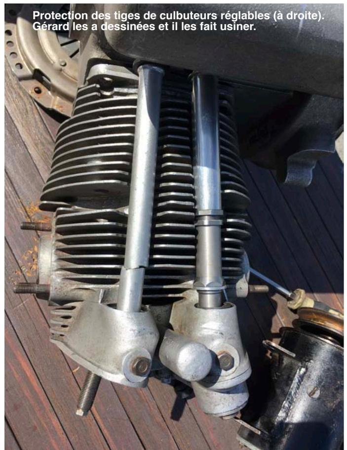
Protection des tiges de culbuteurs réglables (à droite). Gérard les a dessinées et il les fait usiner.
